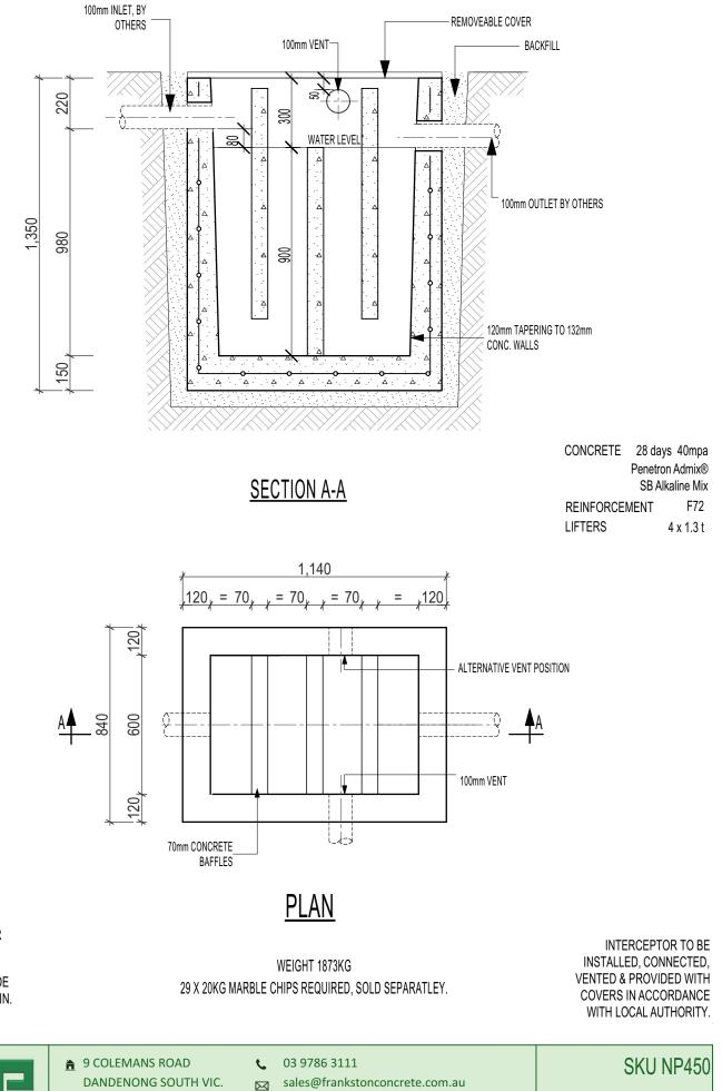
CAST IRON ACCESS COVERS TO SUIT: - LIGHT DUTY (55MM) OR - HEAVY DUTY (100MM)
